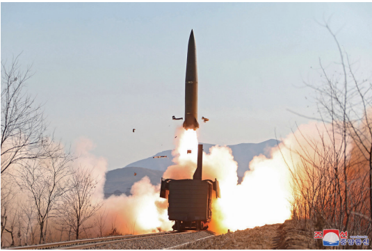
〈철로 위 열차에서 발사되는 'KN-23'(북한판 이스칸데르 전술유도탄)의 모습. 북한은 이를 철도기동미사일체계로 지칭한다. 북한 전역에 촘촘하게 깔린 철도망을 이용해 어느 지역에서든 미사일을 쏠 수 있다. (사진=조선중앙통신)〉
