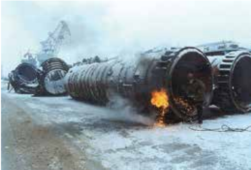
〈1990년대 러시아에서 '협력적 위협감소' 프로그램에 따라 구소련의 대륙간 탄도미사일(ICBM)을 해체하는 모습 (위키피디아)〉
